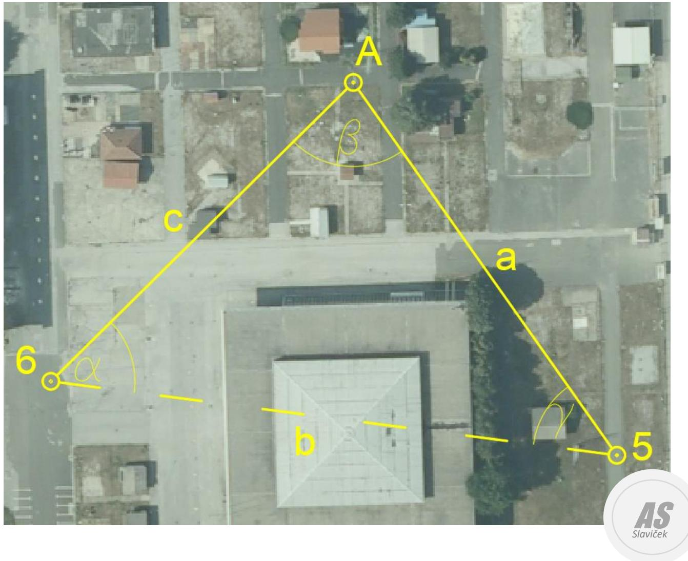
Kada se između točaka poligonske stranice (P5 i P6) nalazi prepreka, tako da se one ne dogledaju, tada razvijemo trokut u kojem ćemo izmjeriti dvije stranice (a i c) i kut koje one zatvaraju ( $\beta$ ).
