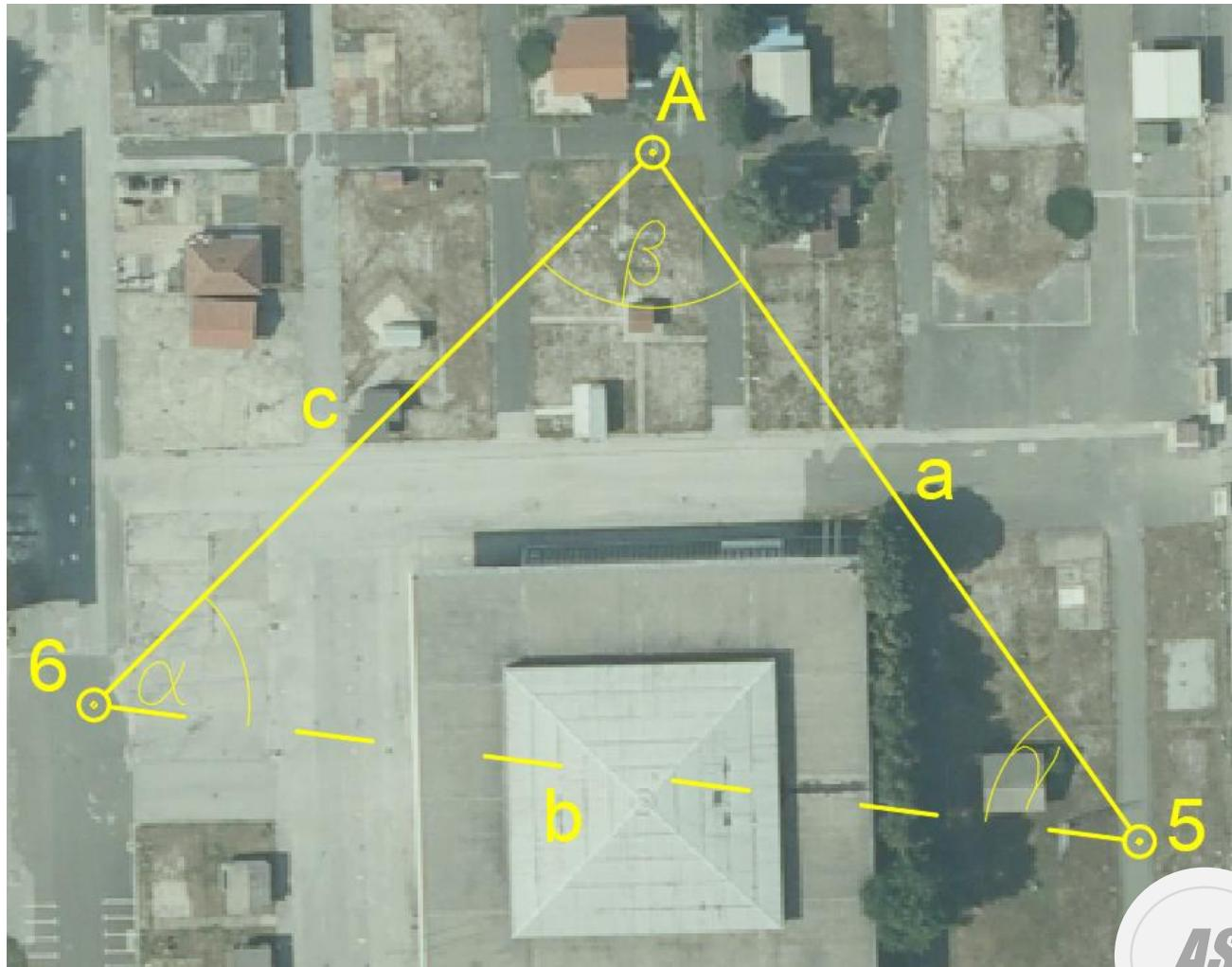
Kada se između točaka poligonske stranice ( $P_5$  i  $P_6$ ) nalazi prepreka, tako da se one ne dogledaju, tada razvijemo trokut u kojem ćemo izmjeriti dvije stranice ( $a$  i  $c$ ) i kut koje one zatvaraju ( $\beta$ ).
